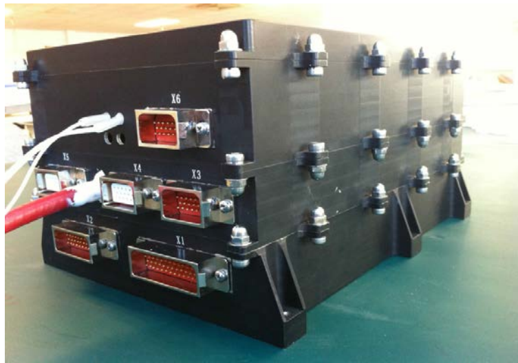
图1 高压输出电源设备照片
